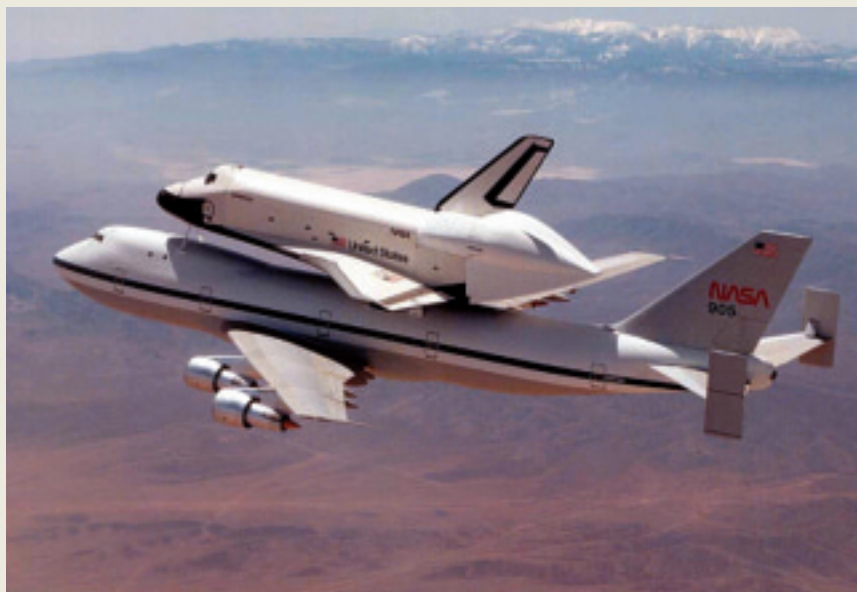
從未真正上過太空的「企業號」太空梭，正騎在波音747上進行飛航測試。
